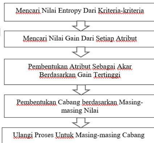
Gambar 1. Algoritma Penyelesaian Algoritma C4.5
