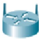
Perangkat keras yang memungkinkan perangkat wireless lain (seperti laptop, ponsel) untuk terhubung ke jaringan kabel menggunakan wi-fi, Bluetooth atau perangkat standar lainnya
